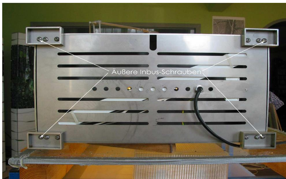
Abb. 14 - Inbus-Schrauben zum Lösen der Grundplatte
