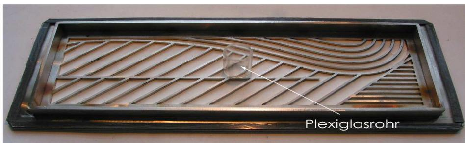
Abb. 12 - Deckelunterseite mit Plexiglasrohr
