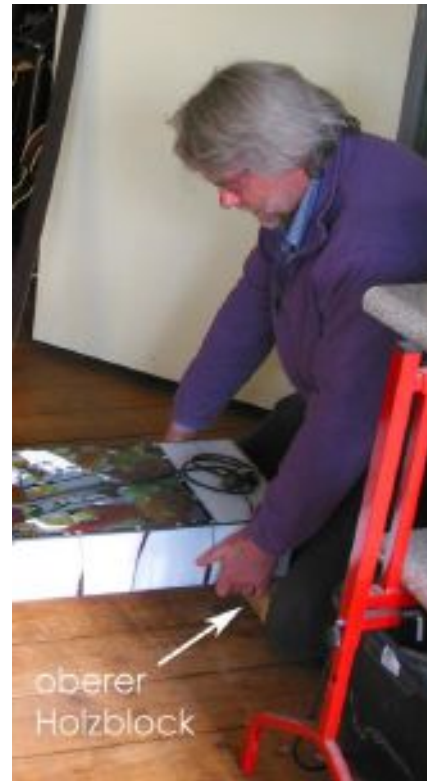
Abb. 6 - Ablegen auf dem oberen Holzblock
