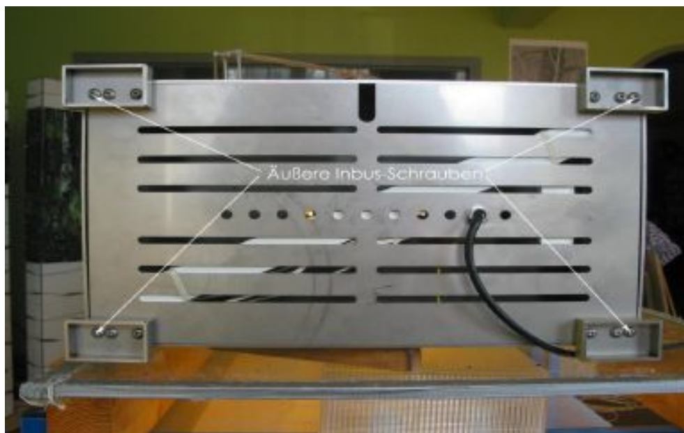
Abb. 9 - Inbus-Schrauben zum Lösen der Grundplatte
