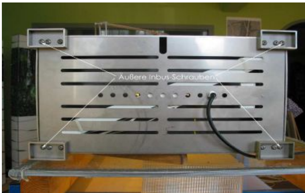
Abb. 14 - Inbus-Schrauben zum Lösen der Grundplatte
